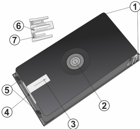
Abb. 1: Panik- und Notfalltaster auf zugehöriger Montageplatte: 1. Scharniere, 2. Taster A, 3. Schalter B, 4. Rückplatten-Befestigungsschraube, 5. Montageplatte-Schnappriegel, 6. Abnehmbare Banknoten- oder Dokumentenklammer, 7. LED-Lampen-Führungsschiene.
